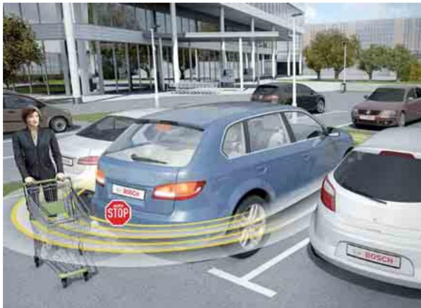
Frenata di emergenza assistita in manovra: a velocità fino a 10 km/h sensori a ultrasuoni monitorano l'area intorno al veicolo. Il sistema individua gli ostacoli, avvertendo il guidatore in caso di rischio di collisione. E in assenza di reazione ferma la vettura
